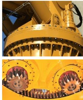
El doble moto-reductor de giro permite trabajar sin reducción de potencia con escoras, de hasta 7°
