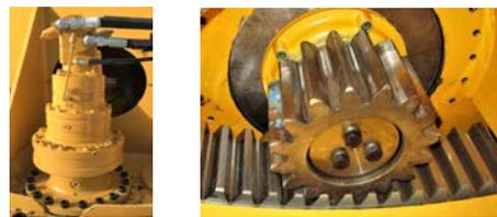
El doble moto-reductor de giro permite trabajar sin reducción de potencia con escoras, hasta 10°
