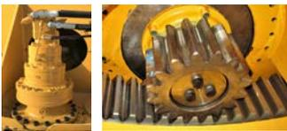
El doble moto-reductor de giro permite trabajar sin reducción de potencia con escoras, hasta 10°
